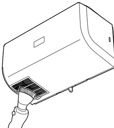
■汚れがひどい場合は、ルーバー、排気フィルター、給気清浄フィルター、羽根をはずしてお手入れをしてください。(7~9ページ参照)
